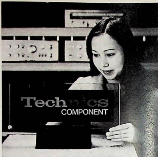
Oben: Erstmals für einen Schaufensteraufsteller wird in Japan neuerdings eine elektrophoretische Anordnung verwendet, bei der sich in einer Flüssigkeit zwischen zwei Scheiben schwebende Teilchen unter dem Einfluß einer elektrischen Gleichspannung in einer von zwei möglichen Lagen anordnen. Dadurch lassen sich Schriftzeichen in wechselnden Farben scharf und kontrastreich darstellen. Das von Matsushita entwickelte Display wird unter der Bezeichnung „Epid“ herausgebracht.
